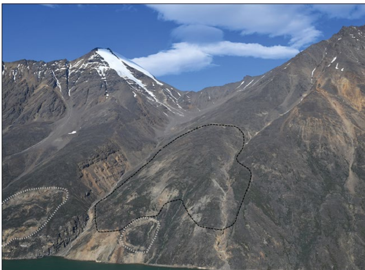
Figur 2: Kigarsima lokaliteten. Den sorte stiplede linje viser omfanget af det ustabile område kortlagt ud fra InSAR. Bemærk at der også neden for det store ustabile område og på den modsatte side af kløften er to mindre områder i bevægelse (markeret med grå stiplede linje), som dog vurderes at have volumener, der er for små til at kunne forårsage en markant tsunami.
